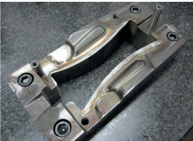
Wiederhergestellte Stanzmatrize: Sie entspricht in diesem Zustand bereits der Nachbearbeitung für den Einsatz in einem Folgeverbundwerkzeug.
