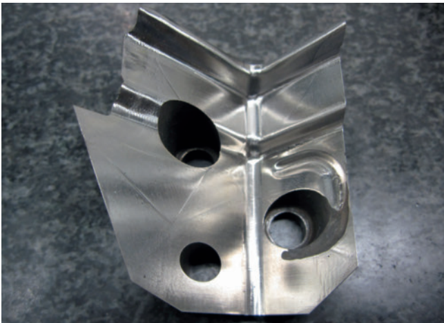
Formschneideinsatz: Bei diesem ist ein formschlüssiges Aufliegen des Materials wichtig, wobei 3D-Scans den Soll-Ist-Vergleich erleichtern.
