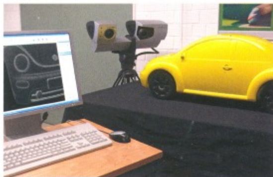
Ein High-End-Projektionscanner bei der 3D-Digitalisierung fertigt bei der Padelt 3D Systeme GmbH im Kundenauftrag präzise Datensätze für Reverse Engineering und Vermessung an.
